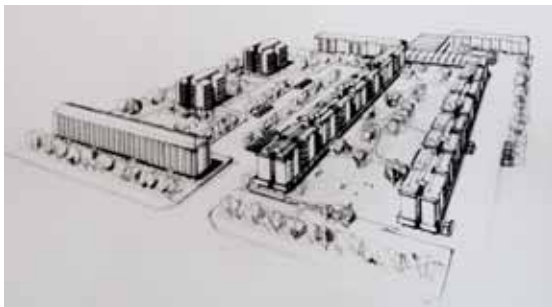
Disegno della veduta assonometrica del "Lottone" a Torricento, Firenze, fra via Argingrosso e via S. Maria a Cintoia. Progetto redatto dall'Ufficio tecnico dello Iacp per la realizzazione di 8 edifici con 365 appartamenti e 18 negozi (1971-1977)
