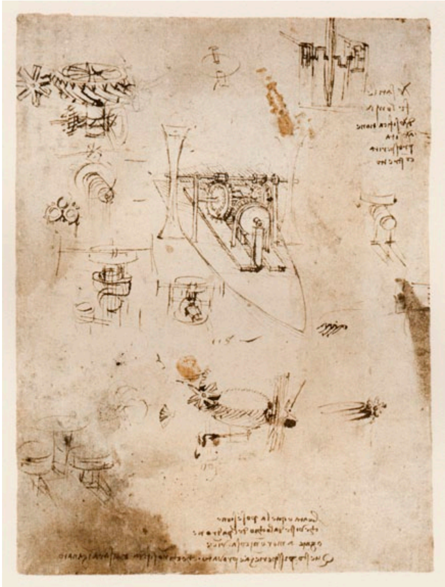
Fig. 25. Natante a pale ruotanti presumibilmente azionate da un meccanismo di propulsione a pedali. Leonardo da Vinci, Codice Atlantico , f. 945r., 1487-1489 circa, Biblioteca Ambrosiana, Milano. Ripr. facs.: Leonardo Da Vinci, Il Codice Atlantico di Leonardo da Vinci , Firenze, Giunti Barbèra, 1973-1975.
