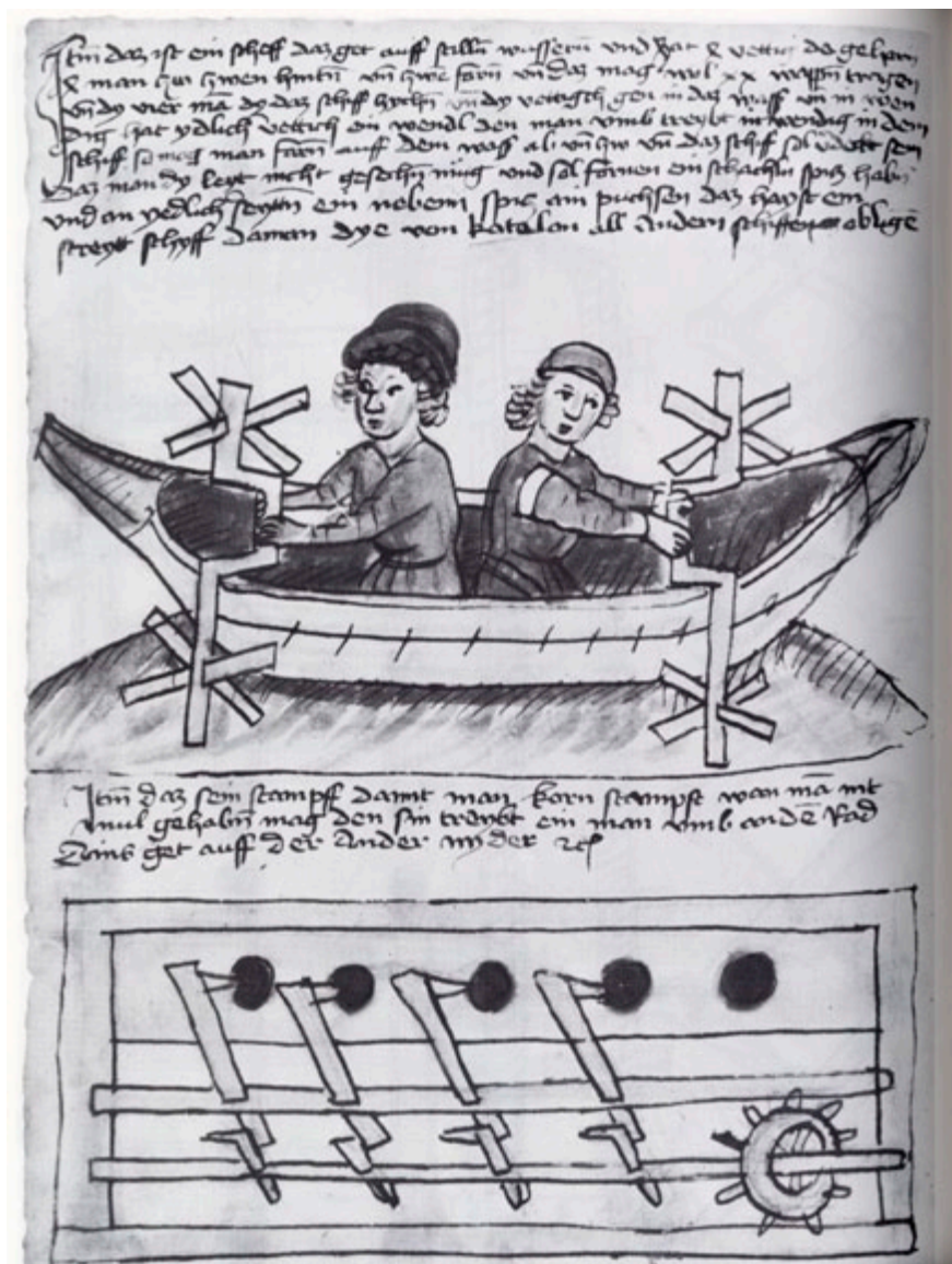
Fig. 5. Imbarcazione spinta da ruote a pale. Anonimo della guerra bussita , Codex Latinus Monacensis 197, Parte 1, f. 17v., seconda metà del XV sec. circa, Bayerische Staatsbibliothek, Monaco. Ripr. facs.: B.S. Hall, The technological illustrations of the so-called "Anonymus of the Hussite Wars" . Codex Latinus Monacensis, 197, Part 1, Wiesbaden, Reichert Verlag, 1979.
