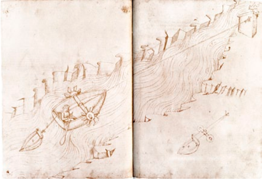
Fig. 9. Piccola imbarcazione da trasporto controcorrente, con pale fissate ad un subbio azionato da una corda tirata per un capo da una barca spinta dalla corrente ed ancorata all'altro capo a monte dell'imbarcazione. Mariano di Jacopo detto il Taccola, Liber tertius de ingeneis ac ediftiis non usitatis , Ms. Palat. 766, ff. 44v.-45r., 1427-1433 circa, Biblioteca Nazionale Centrale, Firenze. Ripr. facs.: Mariano di Jacopo detto Il Taccola, Liber tertius de ingeneis ac ediftiis non usitatis , a cura di J. H. Beck, Milano, Il Polifilo, 1969.
