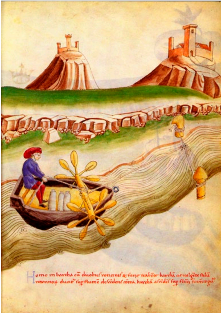
Fig. 8. Piccola imbarcazione da trasporto controcorrente, con pale fissate ad un subbio azionato da una corda tirata per un capo dal barcaiolo ed ancorata all'altro capo a monte dell'imbarcazione. Mariano di Jacopo detto il Taccola, De rebus militaribus (De machinis 1449) , codice Santini, f. 87r., tra il 1449 e il 1475 circa, Bibliothèque Nationale, Paris. Ripr. facs.: L'art de la guerre: machines et stratagèmes de Taccola, ingénieur de la Renaissance , présenté par E. Knobloch, Paris, Gallimard, 1992.
