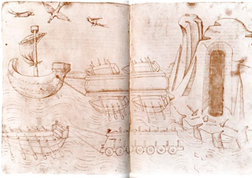
Fig. 10. Sistema integrato terra-acqua per il trasporto di marmi. Mariano di Jacopo detto il Taccola, Liber tertius de ingeneis ac ediftiis non usitatis , Ms. Palat. 766, ff. 14v.-15r., 1427-1433 circa, Biblioteca Nazionale Centrale, Firenze. Ripr. facs.: Mariano di Jacopo detto Il Taccola, Liber tertius de ingeneis ac ediftiis non usitatis , a cura di J. H. Beck, Milano, Il Poliflo, 1969.
